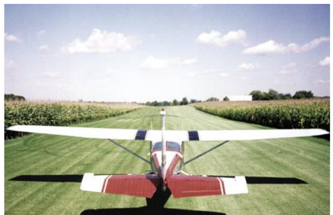
Figura 10-16. La performance de una aeronave depende grandemente de la superficie de la pista.
