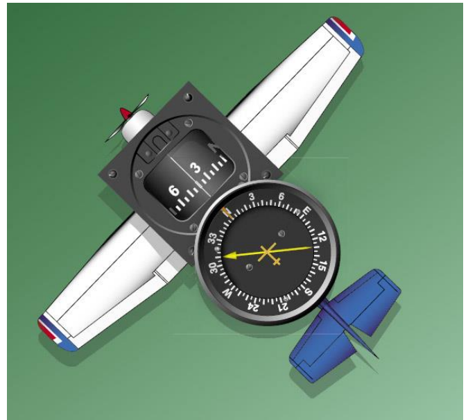
Figura 15-36. ADF con esfera fija y compás magnético.
