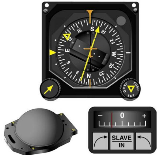
Figura 7-29. Indicador gráfico de navegación (HSI, arriba), medidor esclavo (abajo derecha), y unidad de control y compensación esclava (abajo izquierda).
