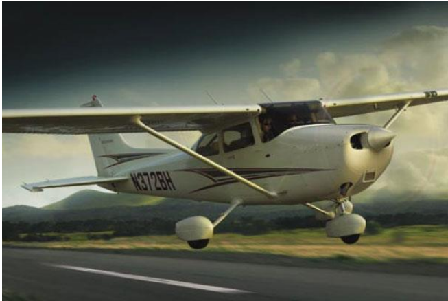
Figura 6-37. El tren de aterrizaje soporta al avión durante la carrera de despegue, aterrizaje, rodaje y estacionamiento.
