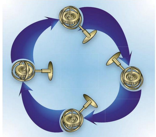
Figura 7-18. Independientemente de la posición de su base, un giróscopo tiende a permanecer rígido en el espacio, con su eje de rotación apuntando en una dirección constante.
