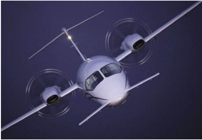
Figura 5-14. El Piaggio P180 incluye un diseño canard de flecha variable, que provee estabilidad longitudinal sobre el eje lateral.
