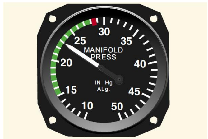
Figura 6-9. La potencia del motor se indica en el medidor de presión del múltiple de admisión.
