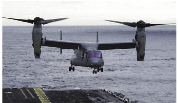
Figura 4-4. Algunas aeronaves tienen la habilidad de cambiar la dirección del empuje
