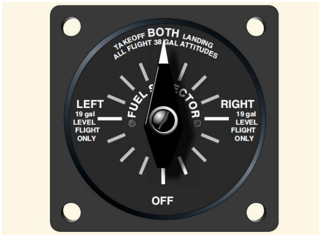
Figura 6-31. Selector de combustible.
