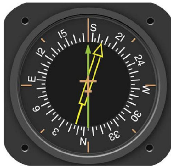
Figura 7-30. Movida por señales de la válvula de flujo, la esfera en este RMI indica el rumbo de la aeronave en la marca superior central. La aguja verde es movida por el ADF.
