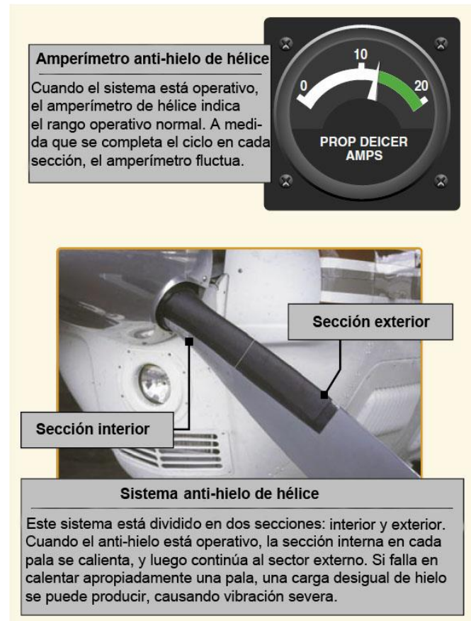
Figura 6-50. Botas anti-hielo y amperímetro de hélice.
