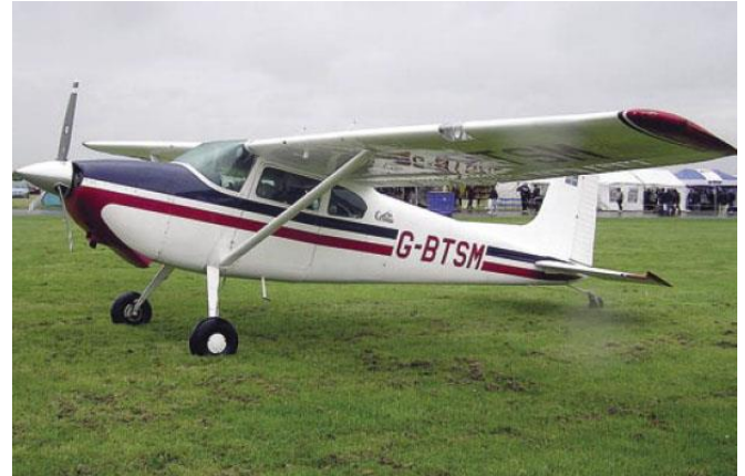
Figura 6-38. Tren de aterrizaje convencional.
