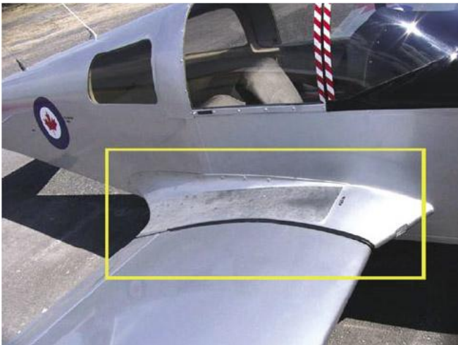
Figura 4-6. La raíz alar puede causar resistencia de interferencia
