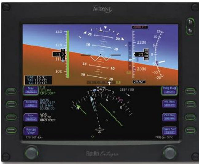
Figura 7-14. Ejemplos de pantallas configurables (FlightLogic de Chelton y Entegra de Avidyne)
