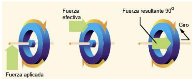
Figura 4-41. Precesión giroscópica
