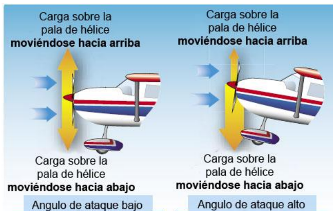
Figura 4-43. Carga asimétrica de la hélice (Factor P )
