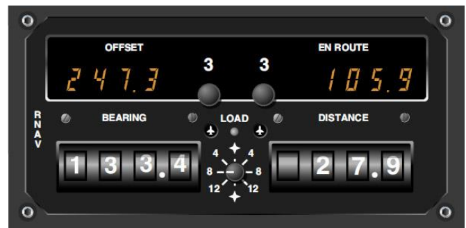
Figura 15-35. Controles del RNAV.
