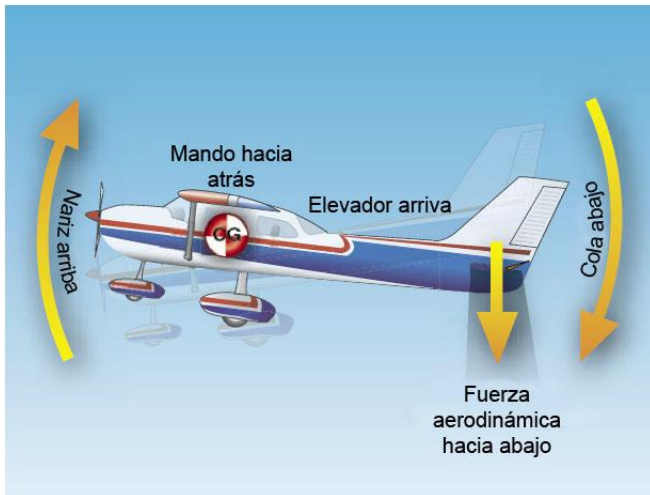
Figura 5-10. El elevador es el control primario para cambiar el cabeceo de una aeronave.
