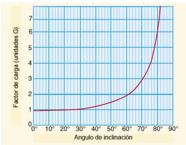
Figura 4-45. El ángulo de inclinación varía el factor de carga
