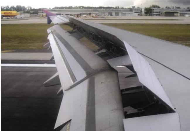
Figura 5-19. Los spoilers reducen la sustentación y aumentan la resistencia durante el descenso y el aterrizaje.
