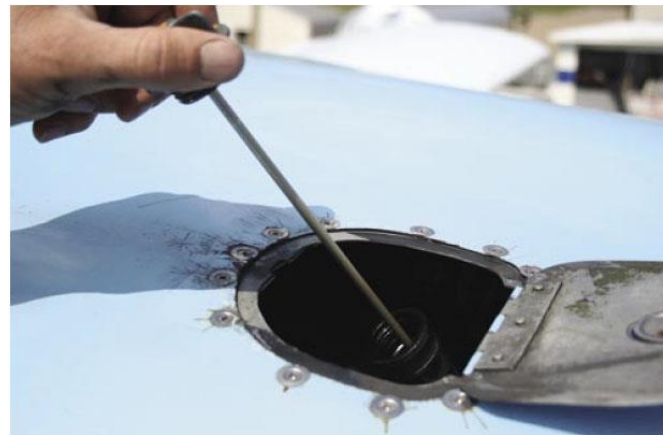
Figura 6-18. Siempre controle el nivel de aceite en la inspección pre vuelo.
