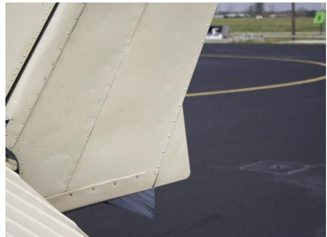
Figura 5-22. Un tab ajustable se usa en el timón de muchos aviones pequeños para corregir la tendencia a volar con el fuselaje ligeramente desalineado al viento relativo.
