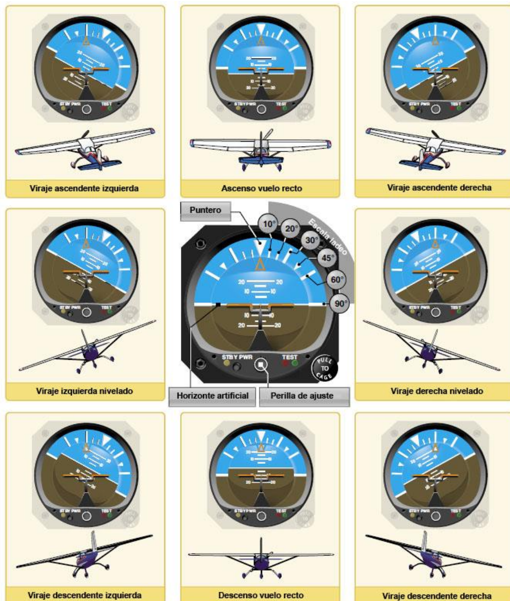
Figura 7-24. La actitud presentada por el indicador de actitud se corresponde a la relación del avión con el horizonte real.
