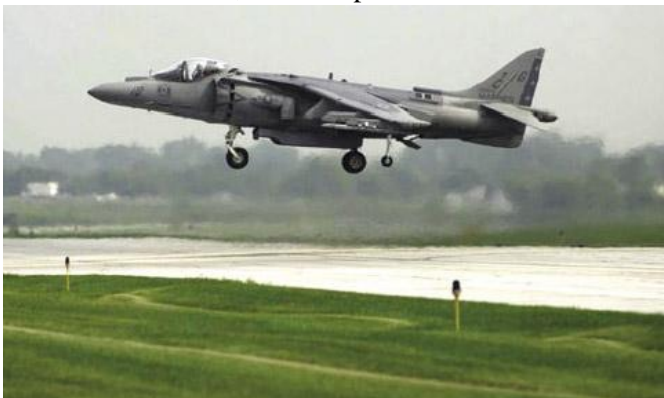
Figura 4-4. Algunas aeronaves tienen la habilidad de cambiar la dirección del empuje
