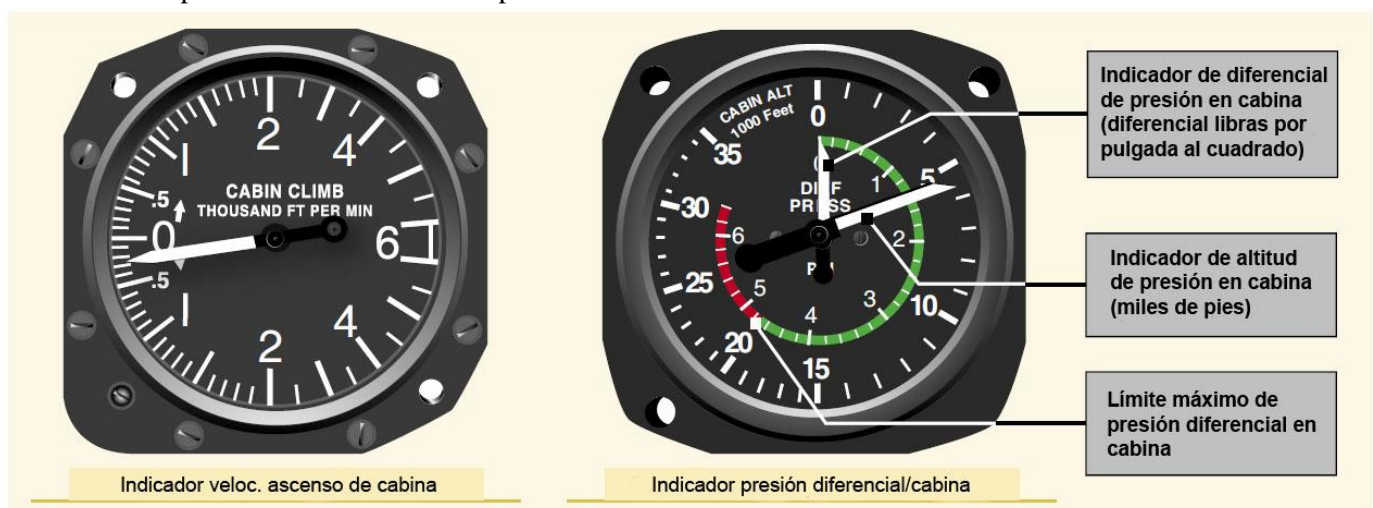
Figura 6-42. Instrumentos de presurización de cabina.
