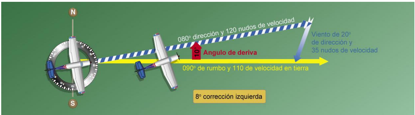
Figura 15-19. Principio del triángulo de velocidades.
