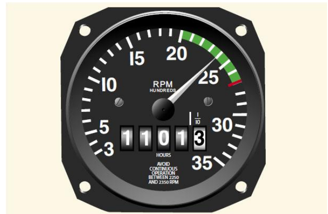
Figura 6-8. Las rpm del motor se indican en el tacómetro.
